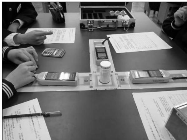
写真4 物質から出る放射線量測定の様子
